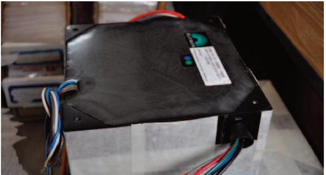
*Particolare di un trasformatore. Si noti il particolare tipo di resina mediante il quale il componente è disaccoppiato dal contenitore. Lo scopo è quello di convertire le residue vibrazioni meccaniche in energia termica*
