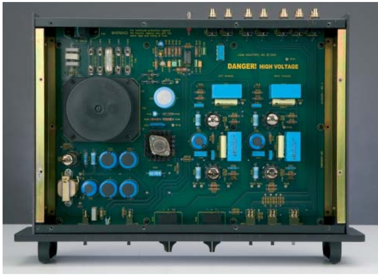
Interno del pre: un tipico esempio di cablaggio inglobato direttamente nel circuito stampato.
