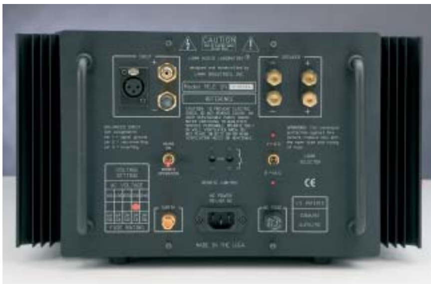
L'unico difetto apparente di questo sistema è rappresentato dal metodo di accensione, che può avvenire tramite gli interruttori a levetta (scomodi da azionare), oppure tramite il comando remoto.
