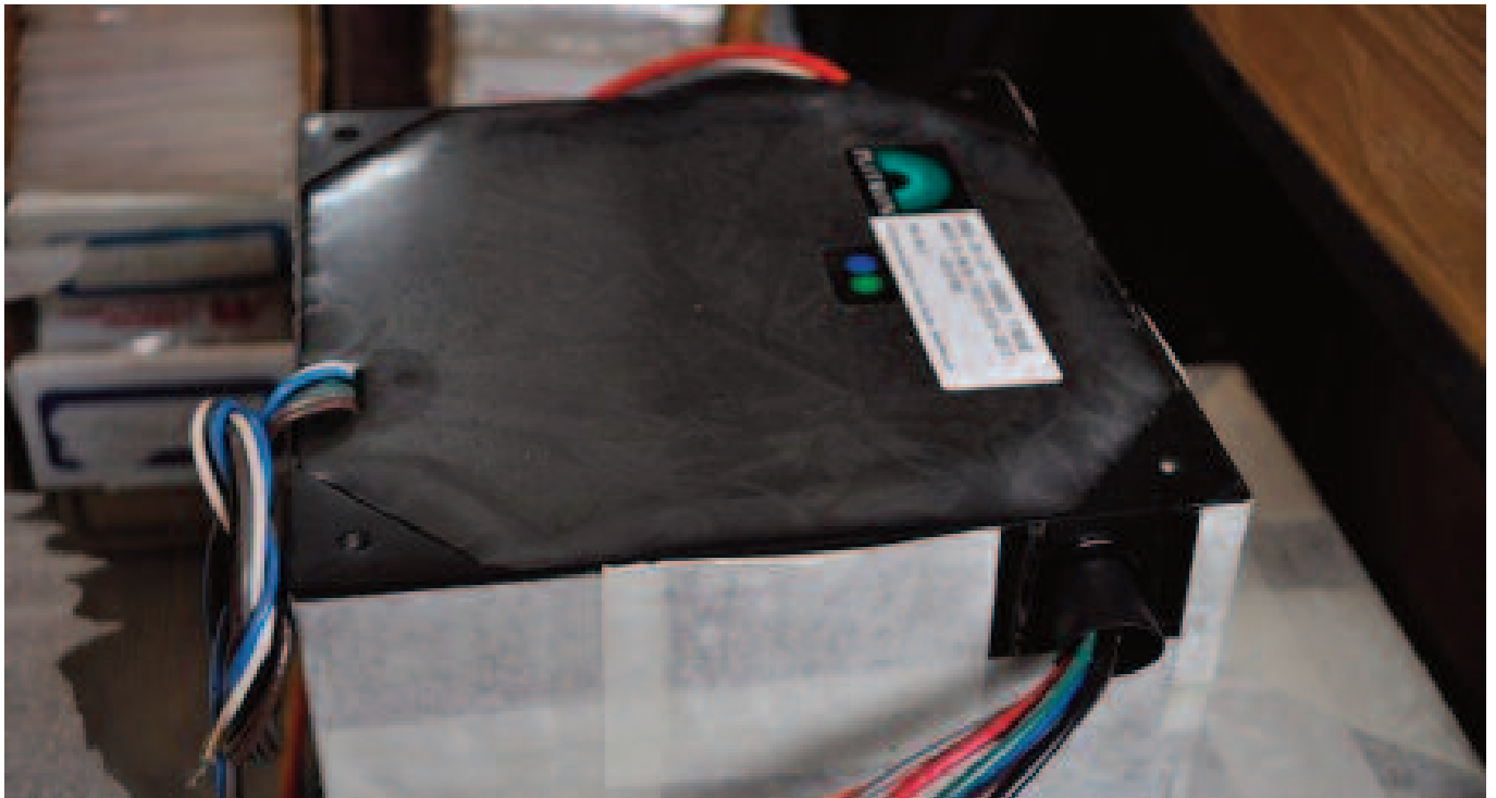
Particolare di un trasformatore. Si noti il particolare tipo di resina mediante il quale il componente è disaccoppiato dal contenitore. Lo scopo è quello di convertire le residue vibrazioni meccaniche in energia termica
